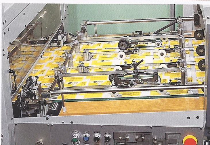
3 Universalanleger mit sich automatisch öffnenden Vorstapelanschlügen bei CE/CER-Modellen
