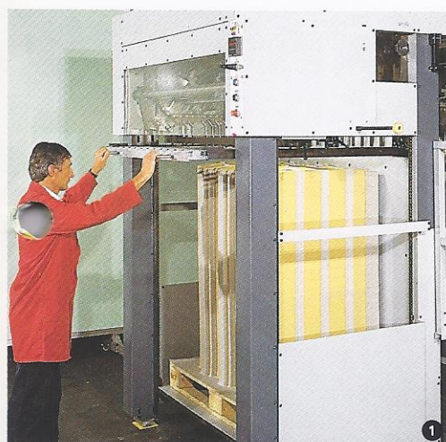
1 Auslage mit manuellem Non-Stop-Auffanggitter bei E/BMA-Modellen
